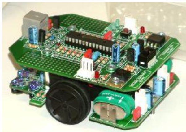
Робот для прохождения лабиринта на базе ATmega8 (соревнования Micromouse competition)
